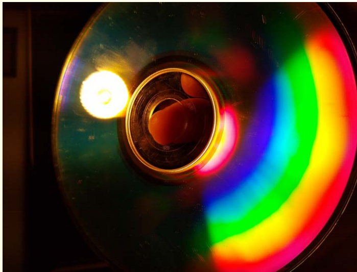
Spektrum einer Halogenlampe auf einer CD
